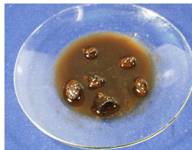
ha az üvegsöves kollektorban kb. 300°C keletkezett, így tud kinézni egy „elromlott” szolár folyadék, pH-ja savas: 6,1
